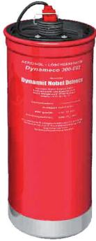
El sistema se basa en la colocación de unos generadores de SOYUZ en el habitáculo a proteger, los cuales, cuando son activados eléctricamente, queman una mezcla pirotécnica que genera un aerosol finalmente difundido por el entorno compuesto de carbonato de potasio ( $K_2CO_3$ ), el cual, es una sustancia NO TÓXICA que interviene eliminando la formación de los radicales que aparecen asociados al fuego y absorbiendo su energía de combustión, por lo que dicho fuego queda extinguido.
