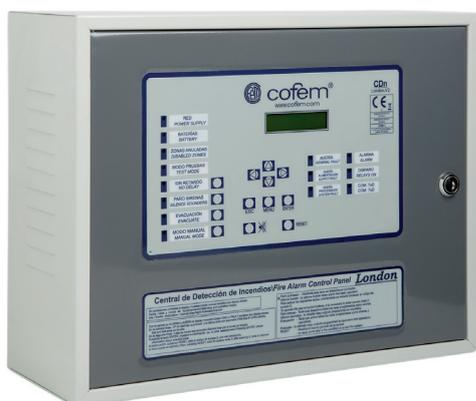
La central LONDON permite conectar hasta un máximo de 10 repetidores, mediante una conexión de 4 hilos de 1,5 mm<sup>2</sup> (dos de alimentación y dos de comunicación para la línea RS485). Los dos hilos de la línea RS485 se conectarán desde el back panel de la central al back panel de sus correspondientes repetidores.
