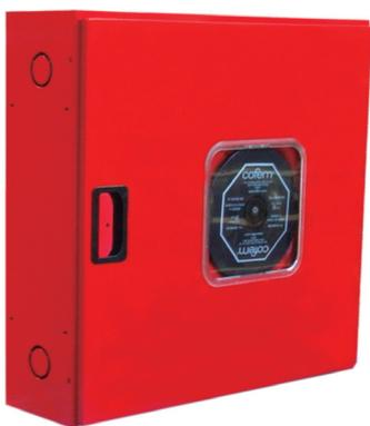
Boca de Incendio Equipada Ø25 mm según norma UNE/EN 671-1 y 20 m de manguera semirrígida fabricada según EN 694:2001.
