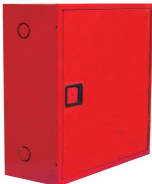
Boca de Incendio Equipada Ø25 mm según norma UNE/EN 671-1 y 20 m de manguera semirrígida fabricada según EN 694:2001.
