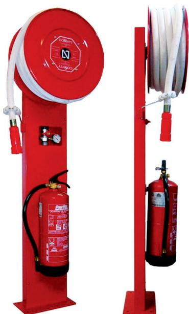
Boca de incendio Equipada Ø25 mm según norma UNE/EN 671-1 y 20 m de manguera semirrígida fabricada según UNE 694.
